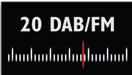
Mit 20 voreingestellten DAB- und 20 voreingestellten UKW-Sendern ist Ihr Liebblingssender immer nur ein paar Tasten entfernt. Um einen voreingestellten Sender zu programmieren, stellen Sie einfach den gewünschten Radiosender ein, und halten Sie die Speichertaste gedrückt. So können Sie die Radiofrequenz ganz schnell automatisch speichern und jederzeit auf Ihren Sender zugreifen.
