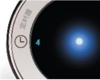
Das Gerät ist für eine festgelegte Anzahl an Stunden in Betrieb und schaltet sich automatisch aus, wenn die eingestellte Zeit vergangen ist.
