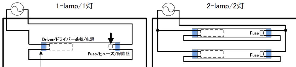
※Driver side has indication of 'L' and 'N'. Driver側には「L」、「N」の印字があります。在灯输入驱动端有“L”以及“N”的标示
