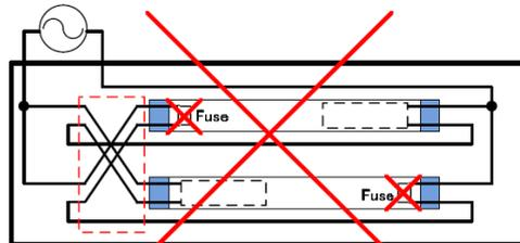
Fuse open/ヒューズが断線します/ 保险丝断线
