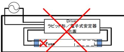
Fuse open/ヒューズが断線します/ 保险丝断线
