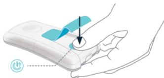
1. Appuyez une fois sur le bouton
