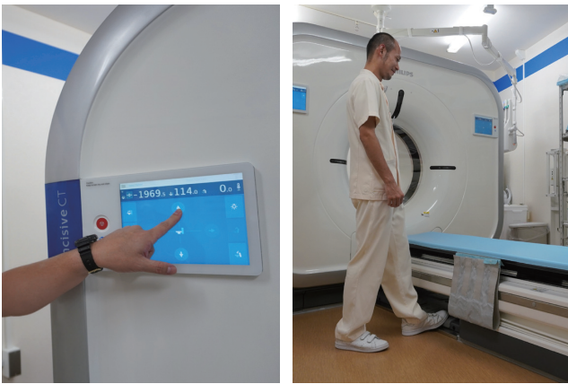
ガントリーのタッチパネルと寝台
