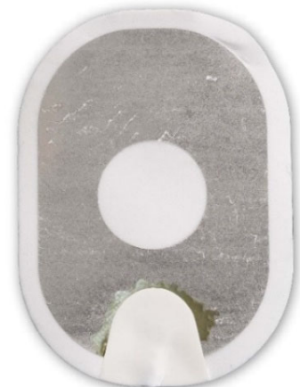
図 3：パッドからゲルの大半が剥離した状態。
