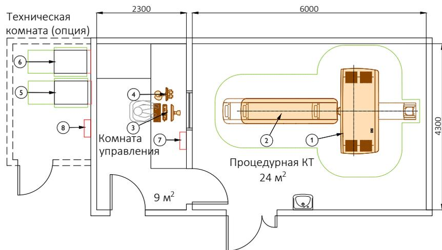
На плане указаны рекомендуемые габариты помещений производителем оборудования. Возможно отклонение габаритов помещений от рекомендуемых, но для этого требуется дополнительное согласование с производителем оборудования - свяжитесь с компанией Филипс для подтверждения технической возможности размещения аппарата.
