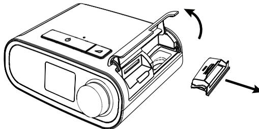
2. Setzen Sie bei Bedarf einen trockenen, wiederverwendbaren blauen Pollenfilter (1) auf einen neuen, optionalen hellblauen Einweg-Spezialfilter (2) und drücken Sie beide fest zusammen, bis sie einrasten.
