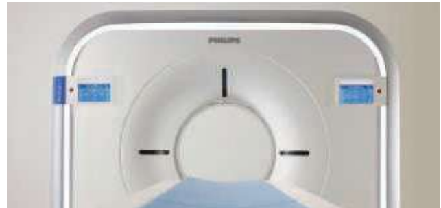
Dwa umieszczone na gantry panele dotykowe pozwalają na wykonanie większej liczby czynności przy pacjencie.
