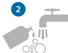
**2** **Chambre** : agitez les pièces dans de l'eau chaude savonneuse additionnée de détergent liquide pendant 1 minute, puis trempez-les pendant 10 minutes.
