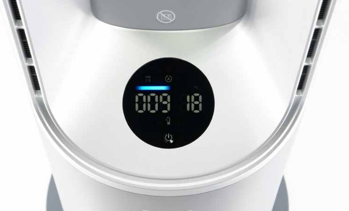
Der Bildschirm des Modells stellt alles Wesentliche in einer verständlichen, auch aus mehr als einem Meter noch problemlos ablesbaren Weise dar: So sind hier bspw. der aktuelle Modus, die einprogrammierten Modusparameter, die Qualität der Luft (PM2.5, VOCs usw.) und verschiedene Hinweise über den Status des Modells einsehbar.
