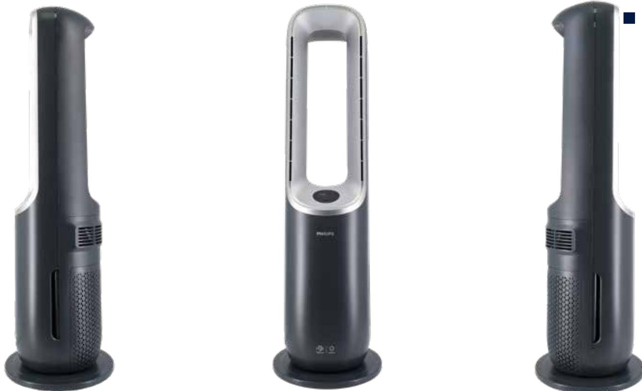
Das Modell kann dank des in ihm vorhandenen Motors auch oszillieren, also den oberen Teil des Modellkörpers pausenlos hin und her drehen, sodass Wärme und Wind einen Großteil des Wohnraums erreichen können. Als Winkelspanne kann man in der App **Air+** eine solche 0–350 Grad einprogrammieren – und das sehr präzise, anhand eines virtuellen Schiebers. Außerhalb der App lassen sich nur Winkelspannen von 45, 90, 180, 270 und 350 Grad einstellen.
