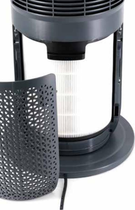
Der Filter ist im FuÙe des Modells vorhanden: Man kann ihn dank der voll abnehmbaren Wand des ModellkÙrpers ohne MÙhen erreichen, herausnehmen und wieder hineinstellen. Das ist vor allem der schwarzen, 11 Millimeter hervorschauenden Materialkappe am oberen Teil des Filters zu verdanken: Hier kann man ihn schlieÙlich mit sicherem Grip packen.
