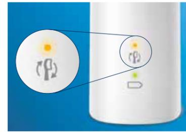
ブラシヘッドに内蔵されたチップにブラッシングの圧力と時間を記録し、適切なブラシの交換タイミングをハンドルのランプでお知らせします。
