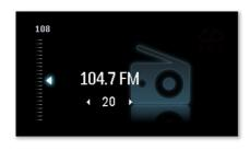
Stellen Sie einfach den gewünschten Radiosender ein, und halten Sie die Speichertaste gedrückt, um die Frequenz zu speichern. Dank der voreingestellten und gespeicherten Radiosender können Sie ganz einfach Ihren Lieblingssender hören, ohne die Frequenz jedes Mal manuell einstellen zu müssen.
