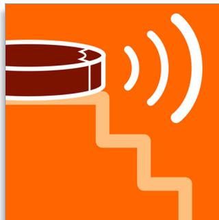
Während der Roboter-Staubsauger in Betrieb ist, sorgen Infrarotsensoren unter dem Gerät dafür, dass er nicht in Hohlräume fällt. Er bewegt sich selbstständig und umfährt dabei Stufen und Vorsprünge.
