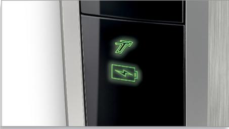
Mit einem Blick auf die Akkuanzeige wissen Sie, ob der Akku fast leer oder vollständig aufgeladen ist. Wenn die Betriebszeit noch 10 Minuten beträgt, leuchtet die Anzeige orange. Beim Aufladen blinkt die Anzeige. Sobald der Akku vollständig geladen ist, leuchtet die Anzeige dauerhaft grün.
