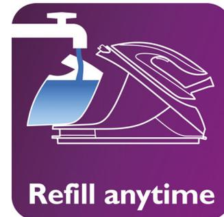
Die Dampfbügelstation wurde für die Verwendung von Leitungswasser entwickelt. Wenn beim Bügeln das Wasser ausgeht, können Sie den Tank einfach während des Bügelns auffüllen, ohne warten und das Gerät ausschalten zu müssen.
