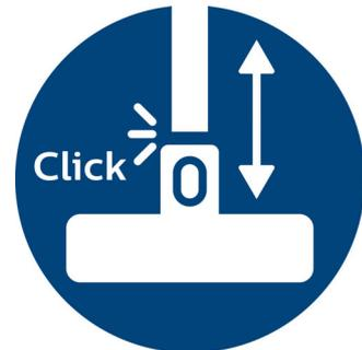
Die ActiveLock-Kupplung ermöglicht es Ihnen, die verschiedenen Düsen und Zubehörteile ganz einfach während der Reinigung am Teleskoprohr anzubringen und wieder abzunehmen.
