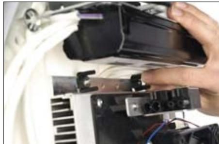
5. Vollständige LEDGINE kann mittels zweier Drehverschlüssen gelöst werden
