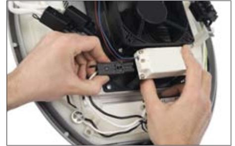
4. Einfache Steckverbinder zum Abtrennen der Stromversorgung vom aktiven Kühlsystem
